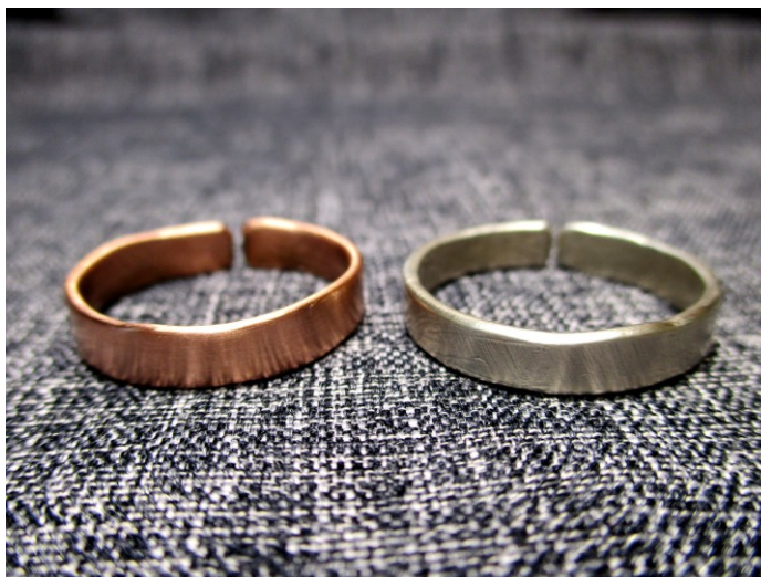
Рис. Сравнительное макрофото двух незамкнутых колец, левое — красная отполированная медь марки М 1, правое — аналогичная медь с гальваническим защитно-декоративным покрытием белой бронзой, визуально, по цвету и оттенку металла, подобно серебру
