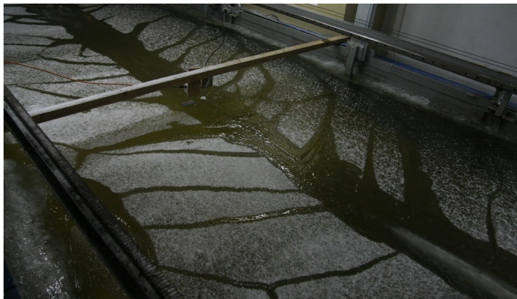
Рис. 11. Характер разрушения ледяного покрова моделью № 3 при b_n/V_m = 0,4 , u_m = 1,85 м/с
