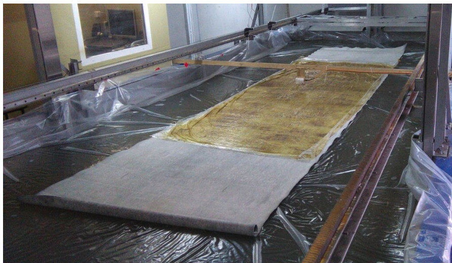
Рис. 1. Общий вид ледового бассейна с неразрушаемой моделью льда
