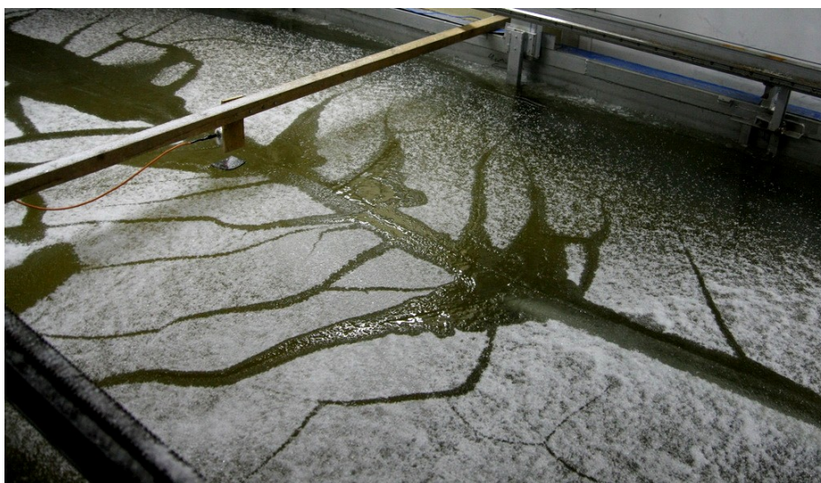
Рис. 10. Характер разрушения ледяного покрова моделью № 2 при движении вдоль продольной трещины, u_m = 1,66 м/с
