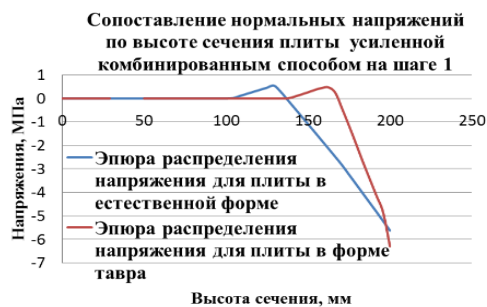
Рис. 5. Сопоставление нормальных напряжений по высоте сечения плит на шаге 1: а) без усиления; б) усиленной наращиванием сечения; в) усиленной дополнительной арматурой; г) усиленной комбинированным способом
