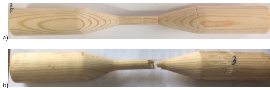
Рис. 4. Испытываемый образец на растяжение: а) до разрушения; б) после разрушения
