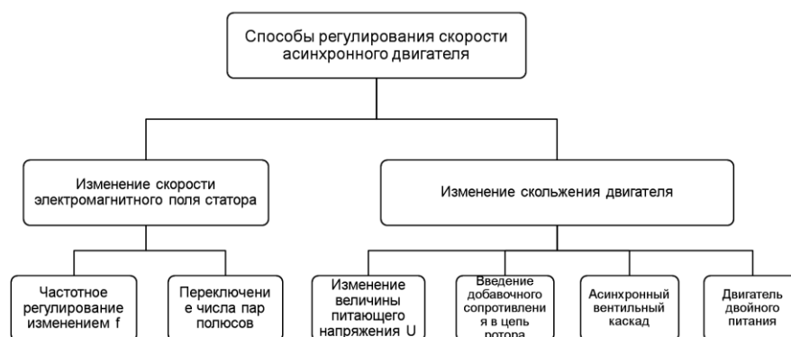
Рис. 1. Способы регулирования скорости асинхронного двигателя
