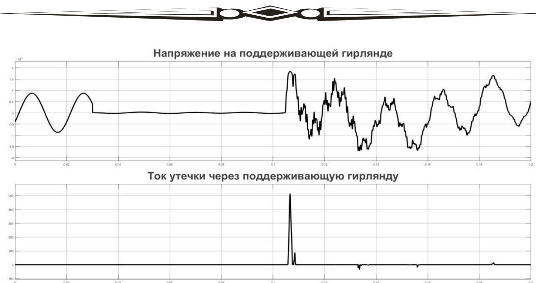
Рис. 2. Напряжение и ток утечки через поддерживающую гирлянду
